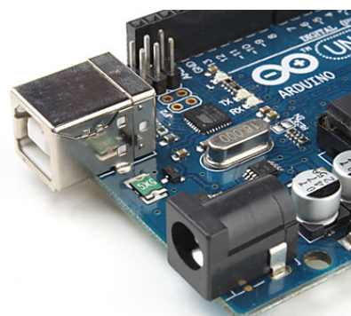
Arduino Unoに搭載されている USBジャックと電源ジャック
